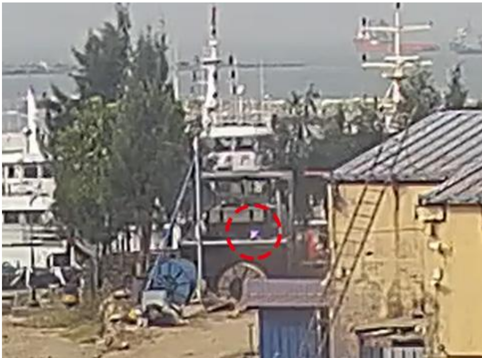
图 2 事故发生时甲板出现的焊接弧光（红圈位置）
